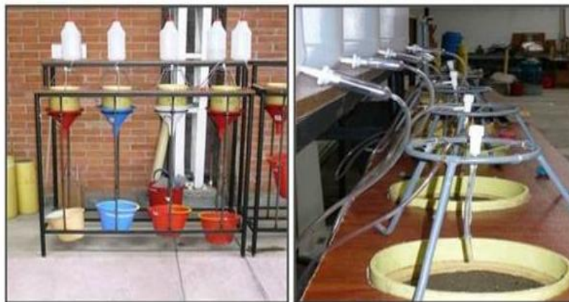
Componentes de la instrumentación utilizada para la realización de las pruebas de conductividad hidráulica Saturada y los experimentos de desplazamiento Miscible
