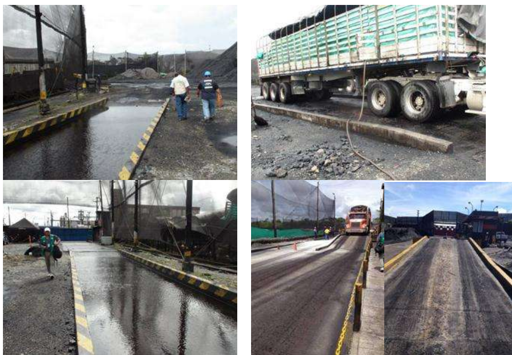
Zonas de Lavado de vehículos en los diferentes patios de almacenamiento de carbón mineral
