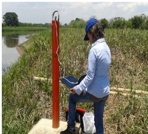
Recolección datos generados por el diver en el Piezómetros construidos
