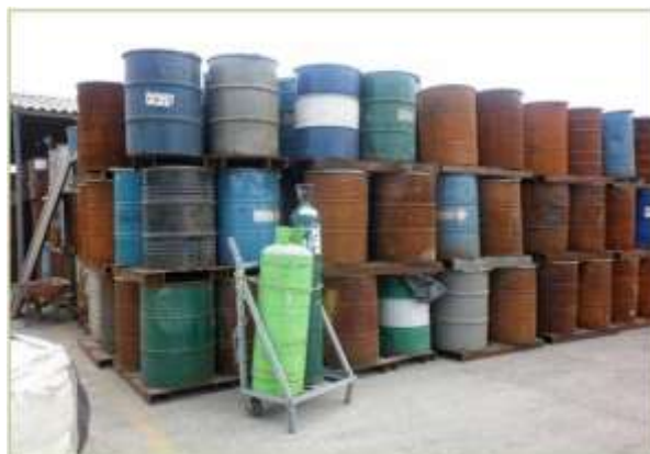
Área de almacenamiento de residuos de escoria de corte, polvo de pulido y granalla de Instrumental S.A., cuyos residuos van a ser aprovechados mediante reingreso a proceso de fusión en Diaco S.A. para la fabricación de acero.
