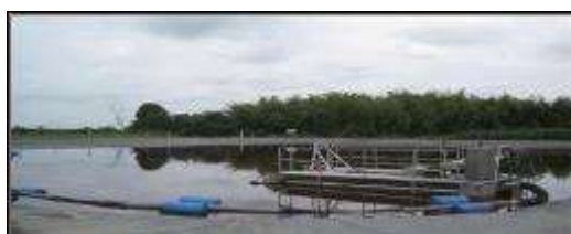
Draga para extracción de lodos de vinaza con bomba hidráulica axial – Ingenio Manuelita y reservorios de almacenamiento de vinazas
