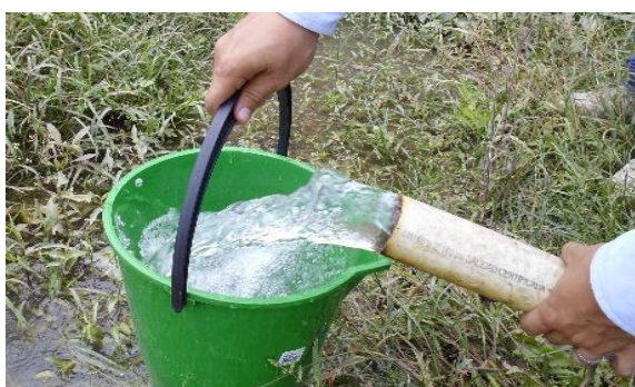
Foto 51 Aforo de pozo para concesión de aguas subterráneas. Fuente: Grupo Recursos Hídricos, DTA. 2016
