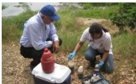
Foto 138. Toma muestra y medición pH en el efluente del relleno sanitario Colomba el Guabal. Archivo CVC, 2016
