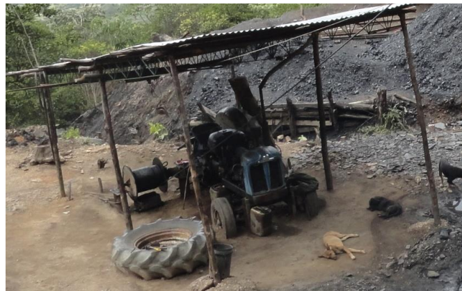
Foto 2: tractor con adición de un malacate para acción de skip.
