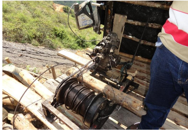
Foto 6: malacate improvisado con motor de motocicleta
