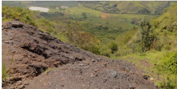
Foto 9: disposición de material de roca caja sobre la ladera de la montaña.
