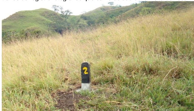
Foto 1: mojón en concreto que referencia punto vértice dos de la poligonal minera, otorgada por la Agencia Nacional de Minería entre contrato CDR-101 y licencia de explotación 20489.
