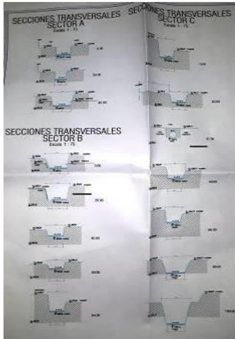
Figura 4: Secciones transversales de la acequia en el tramo de estudio.
