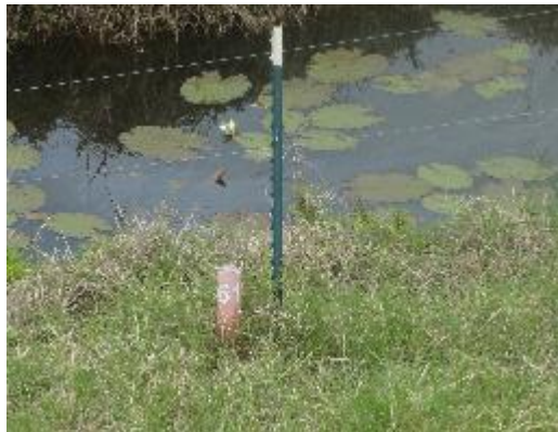
Foto No 11: Mojón para secciones transversales para proceso de batimetría y control de río.
