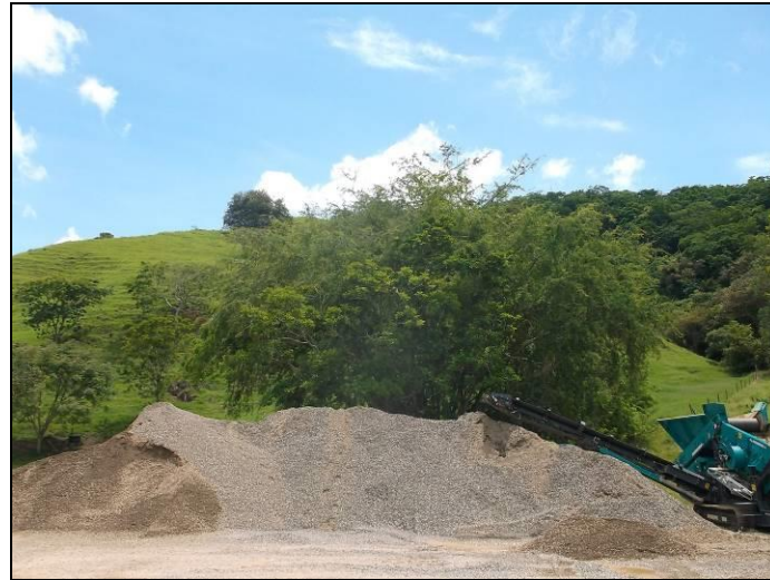
Foto 11. Patio de acopio del material, después de ser triturado y seleccionado.
