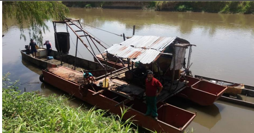
Foto 2. Se observa el equipo mecánico utilizado para la extracción del mineral del lecho del cauce. La capacidad estimada del balde o cajón es de 0.35 mt 3 .
