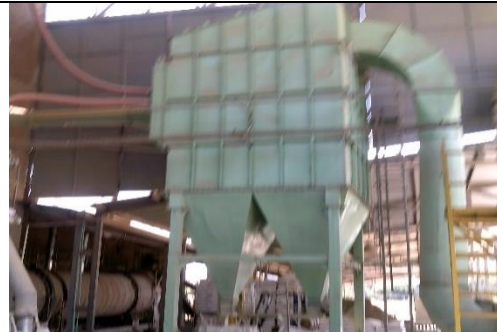
Foto 6. Filtro mangas ubicado posterior a ciclón 12x18
