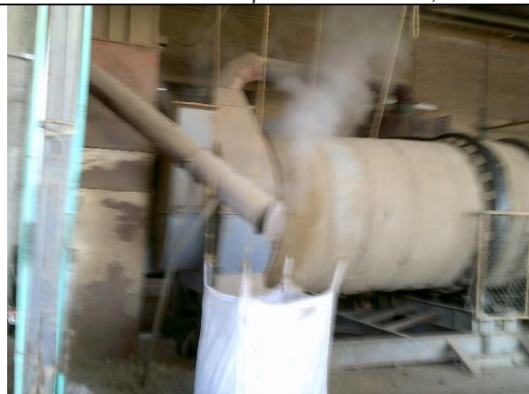
Foto 3. Secador rotatorio a base de G/N @ 5Ton/H
