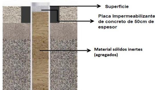
SELLADO DE ALJIBE
