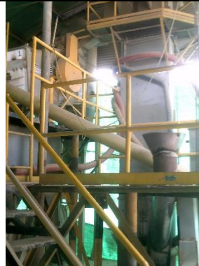
Foto 6. Filtro mangas ubicado posterior a ciclón 12x18
