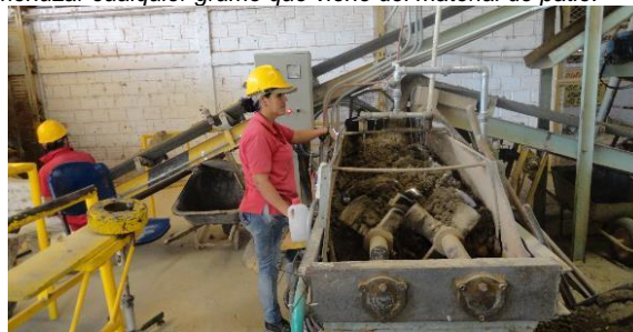
Foto No 3; maquina homogeneizadora con tornillos sinfín.
