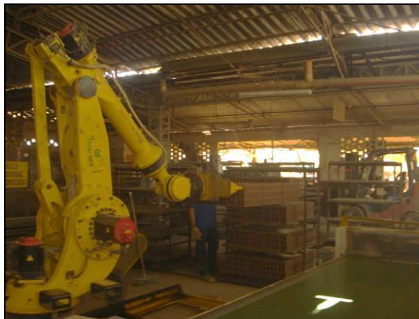
Foto No 8: brazo robótico que dispone los ladrillos para el tren sin fin.
