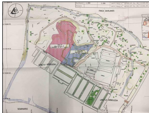
Figura No. 6: plano de plan de cierre donde se ubican las zonas recuperadas y actualmente ocupadas por las urbanizaciones Arboleda I y II, la proyección de la Etapa III y el campo senior club.
