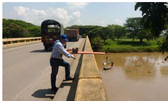
Foto 115. Aforo por suspensión desde puente, estación Río Cauca-Anacaro (municipio de Cartago).
