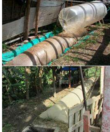
Foto 11. Biodigestores en granjas porcícolas en territorio BRUT.
