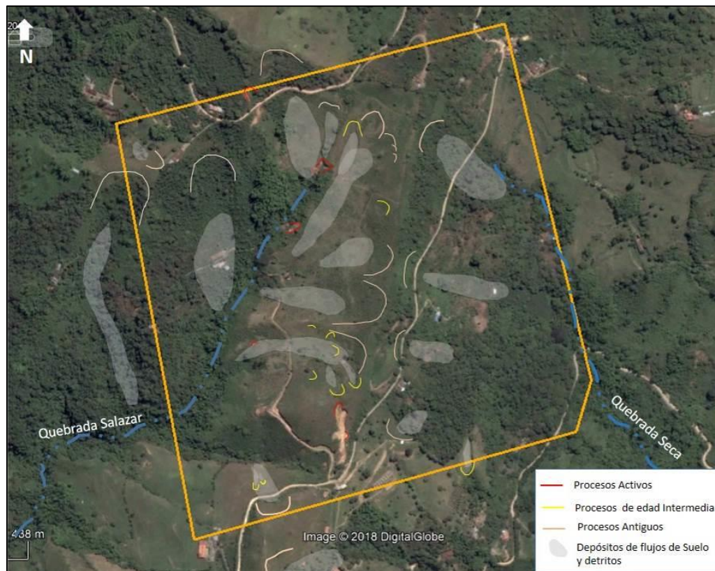
Figura 10. Procesos morfológicos que han afectado la zona. Fuente: Informe de visita del 16 de octubre de 2018, Grupo de Gestión del Riesgo y Cambio Climático de la DTA – CVC.
