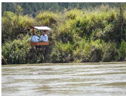
Foto 34. Aforo por suspensión desde tarabita, estación Río Cauca-La Balsa (municipio de Jamundi)
