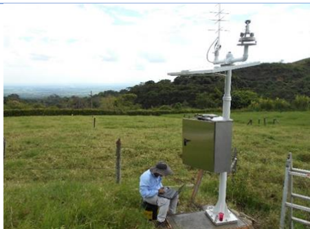
Foto 32. Mantenimiento físico y electrónico realizado en la estación pluviométrica automática El Castillo (municipio de Ginebra)
