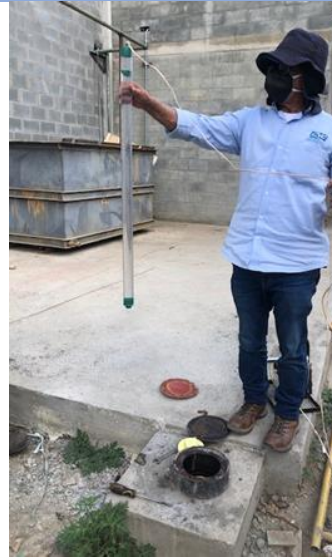
Foto 38. Verificación de construcción de pozos de monitoreo, empresa A y G Ingeniería, municipio de Palmira
