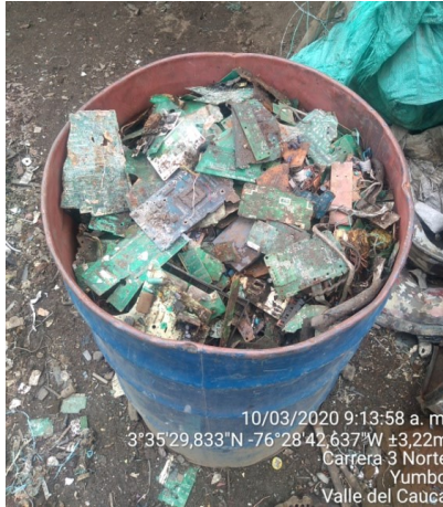
Fotografía 7. Caneca con residuos eléctricos y electrónicos (RAEE) almacenados en el predio.
