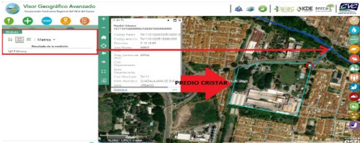
Figura No.3. Ubicación del predio (CRISTAR), respecto de fuentes hídricas (Área intervenir está a 143,5 mts de la corriente hídrica más cercana RIO GUADALAJARA). Fuente Geo-CVC
