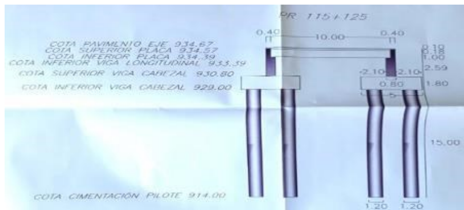
Detalle niveles de cimentación del puente 4: Paso Auxiliar. Fuente INVIAS. (Plano 17 de 17). 2019.
