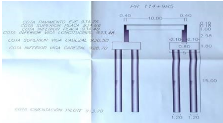
Detalle niveles de cimentación del puente 3: Paso Auxiliar. Fuente INVIAS. (Plano 17 de 17). 2019.
