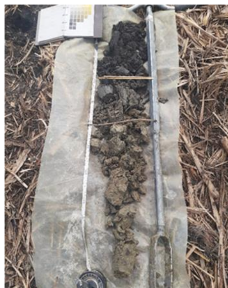
Foto 4. Toma de muestra para el monitoreo a la salinidad en el sector comprendido entre los ríos Fraile y Amaine, municipio de Palmira, Hacienda La Escalera, en el punto FG – 448, Archivo CVC-2022.
