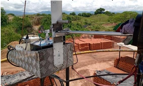
Foto 121. Monitoreo de emisiones atmosféricas en la chimenea de una ladrillera. Archivo CVC
