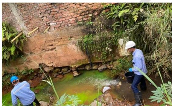
*Foto 45. Inyección de trazadores y caracterización de fuentes superficiales y vertimientos.*
