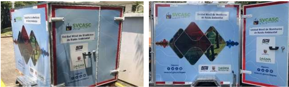
Foto 113. Estación móvil de monitoreo de ruido ambiental para fortalecer la variable de ruido ambiental al Sistema de Vigilancia de Calidad del Aire de Santiago de Cali (SVASC). Fuente: Archivo CVC. 2023.
