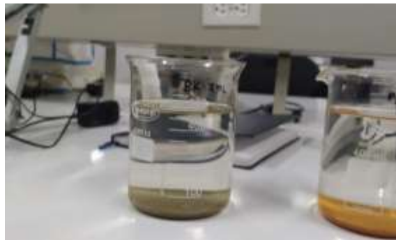
Foto 93. Resultados de ensayos de laboratorio para la factibilidad de uso de lodos a generarse en el tratamiento de drenajes ácidos de minas de carbón como coagulante en el tratamiento de aguas residuales domésticas. Fuente: CVC 2023.
