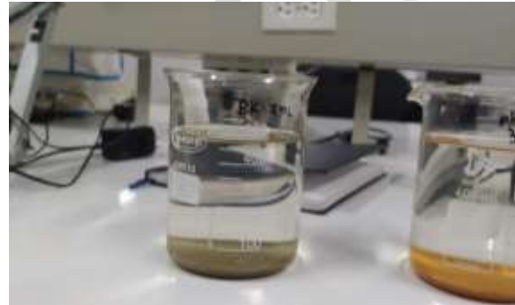
Foto 104. Resultados de ensayos de laboratorio para la factibilidad de uso de lodos a generarse en el tratamiento de drenajes ácidos de minas de carbón como coagulante en el tratamiento de aguas residuales domésticas. Fuente: CVC 2023.
