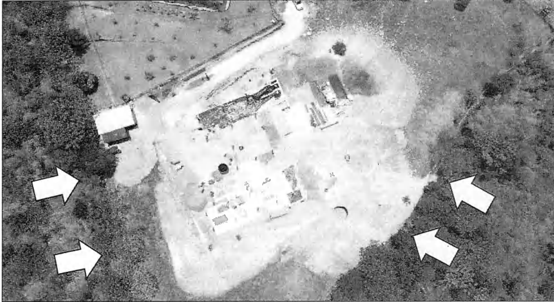
Foto 9. Vista superior de los movimientos de tierra realizados y de las áreas forestales protectoras de corrientes intermitentes (flechas amarillas).
