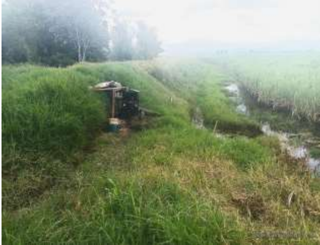
Foto 9 y 10. Extracción de agua por bombeo del cultivo de caña de azúcar al zanjón que comunica el río Cauca con el ecosistema lagunar.
