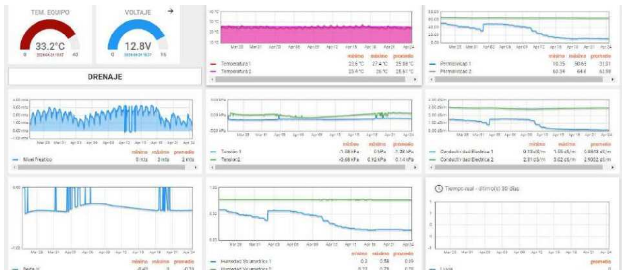
Figura 25. Visualización del dashboard con cada uno de los sensores de calidad de suelo en tiempo real
