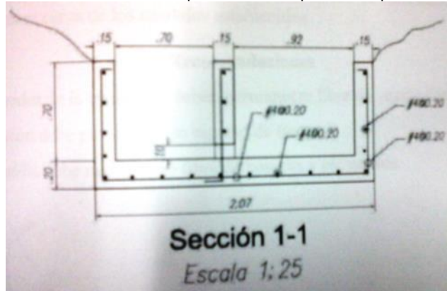
Figura 3: Sección transversal obra de reparto.
