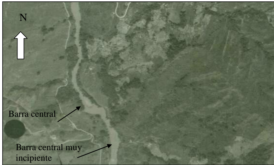
Foto No. 6. Año 1976 (Vuelo C-1651). Se sigue apreciando la barra central de aguas abajo y una zona potencial aguas arriba.
