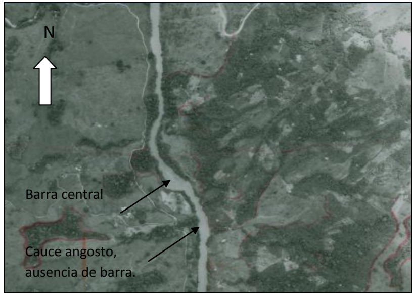
Foto No. 7. Año 1985 (Vuelo . Se observa la barra de aguas abajo. La de aguas arriba ha desaparecido.
