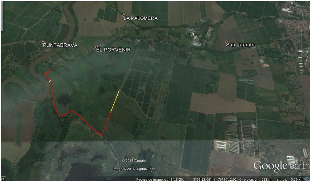
Imagen 2. Trazado del canal y dique. Se resaltan en color amarillo el tramo donde se presenta la menor distancia de las obras con respecto al cauce del río Cauca y el tramo del dique que aún no ha sido levantado
