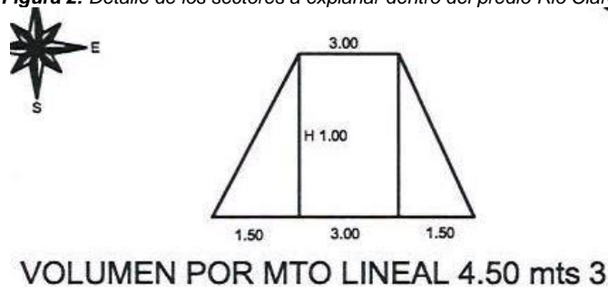
Figura 3: Detalle sección tipo dique perimetral.
