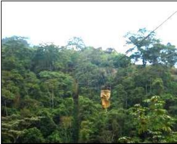
Foto 29: Transporte de material de bocamina en tanques reciclados de Cianuro.
