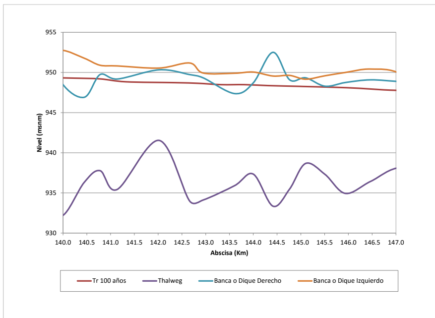
Grafica 1. Perfil longitudinal del nivel de agua en el río Cauca entre las abscisas Km144+000 y Km147+000 para una creciente con periodo de retorno de 100 años
