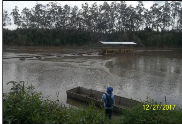
Foto No. 1. Vista de la draga mediante la cual se extrae material en la Arenera Playa Rica.
